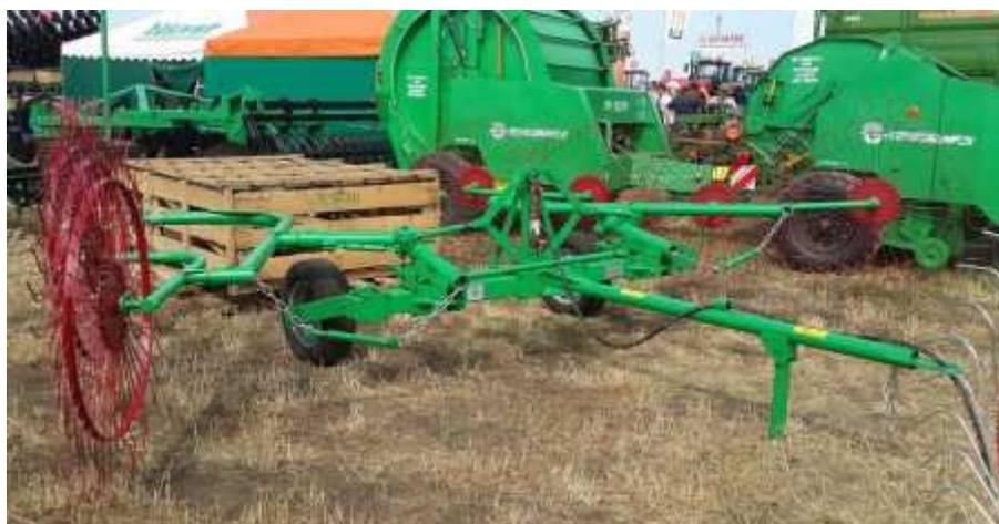
**Грабли-ворошилки колесно-пальцевые ГВВ- 6,0 А** предназначены для сгребания подвяленной и сухой травяной массы (в т.ч. соломы) из прокосов в валки заданной ширины, ворошения ее в прокосах, а также оборачивания валков, попавших под дождь. Обеспечивают высокое качество сбора травы в рыхлый, нескрученный валок.
