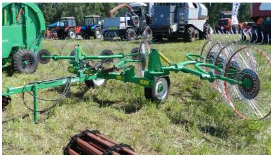
Модель ГКП- 7,3; 6,3; 5,3 предназначены для **сгребания** подвяленной и сухой **травяной массы** (в т.ч. соломы) из прокосов в валки заданной ширины, **ворошения** ее в прокосах, а также **оборачивания** валков, попавших под дождь. Обеспечивают высокое качество сбора травы в рыхлый, нескрученный валок. **Система амортизации** позволяет сгребющим колесам легко адаптироваться **к любому рельефу** почвы для сгребания,
